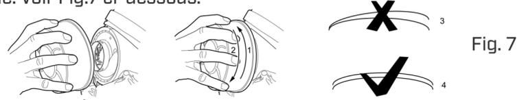
1. Tourner le filtre dans le sens 1 pour engager le filetage puis serrer dans le sens 2 pour monter le filtre sur le respirateur.
