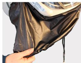
Stellen Sie sicher, dass der Halsriemen am Gehäuse des Atemschutzgeräts befestigt ist und überprüfen Sie die Visierdichtung auf Beschädigungen.
