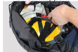
Schalten Sie das Atemschutzgerät ein. Die rote und grüne LED leuchten auf. Sobald sich die rote LED ausschaltet, ist das Atemschutzgerät zum Aufsetzen bereit.
